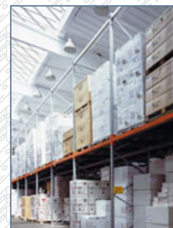
Paletový sklad se dvěma paletami stohovanými nad sebou
