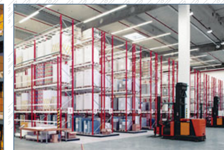
Sklad s výškovými regály pro uskladnění papíru na atypických paletách. Regály jsou obsluhovány vozíkem pro manipulaci v úzkých uličkách
