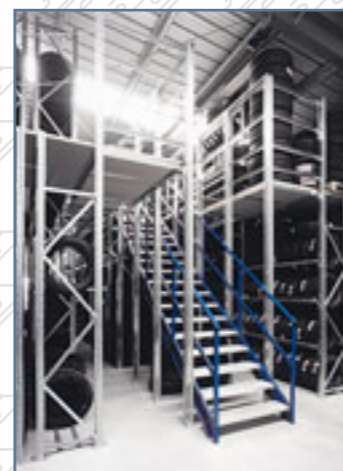
Dvojpodlažní regálová sestava jako sklad pneumatik
